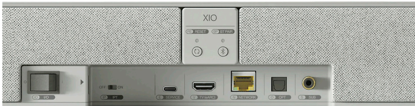
HDMI eARC konektor će, s obzirom na profil uređaja, preuzeti centralno mjesto glede ulaznih konektora/sadržaja, no XIO će se pokazati i kao vrlo sposoban reproduktor mrežnih glazbenih stereo sadržaja
